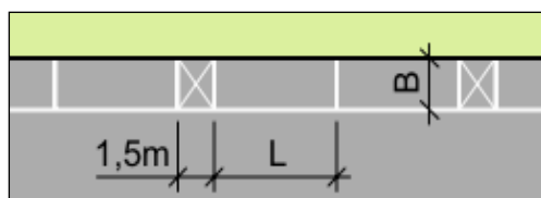
Figur 18: Viser utforming og dimensjoner på parkeringsplasser ved langsgående kantparkering. For personbil benyttes bredde (B) 2m og lengde (L) 5m
