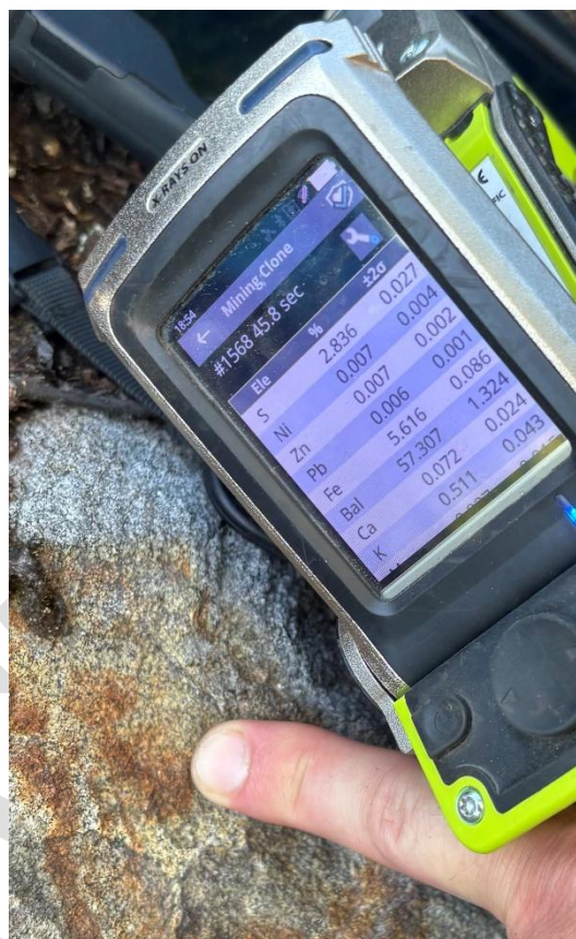
Figur 25. Håndholdt XRF i fra kartlegging av mulige prøvelokaliteter. Analysene kan gjøres rett på fjellet, og gir en god indikasjon på forekommende svovel-konsentrasjoner.
