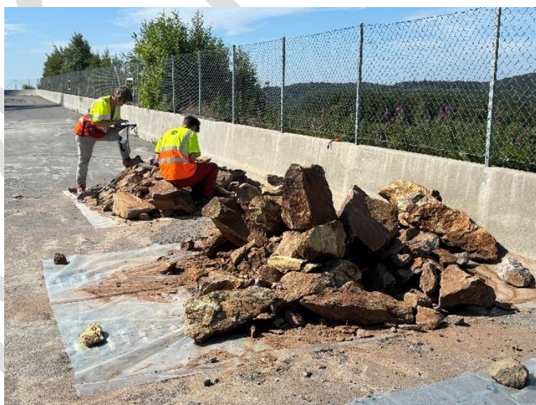
Figur 1. Måling av svovel-% med håndholdt XRF på rigg-plass.
