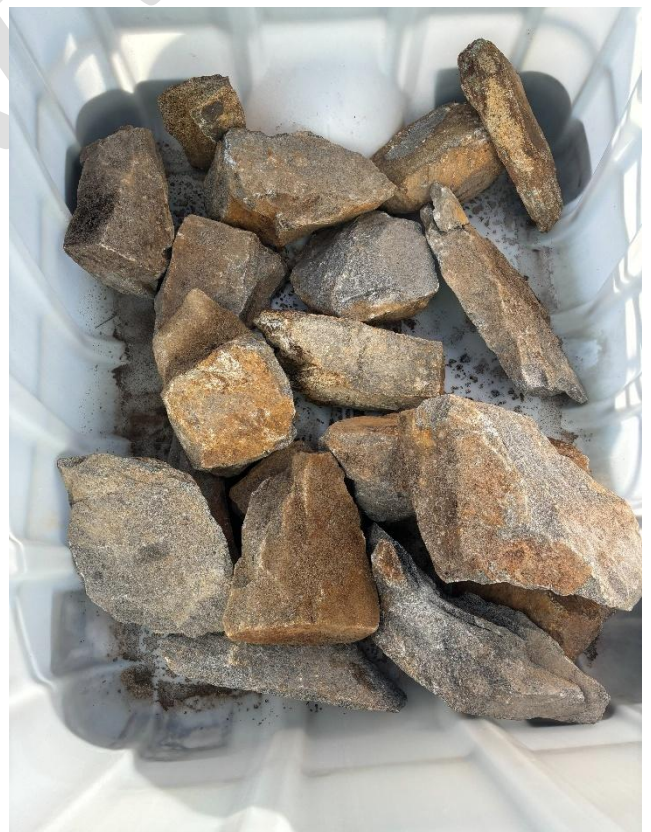
Figur 3.. De første steinene bør legges forsiktig ned i containerne for å forhindre at plasten i bunnen sprekker opp.
