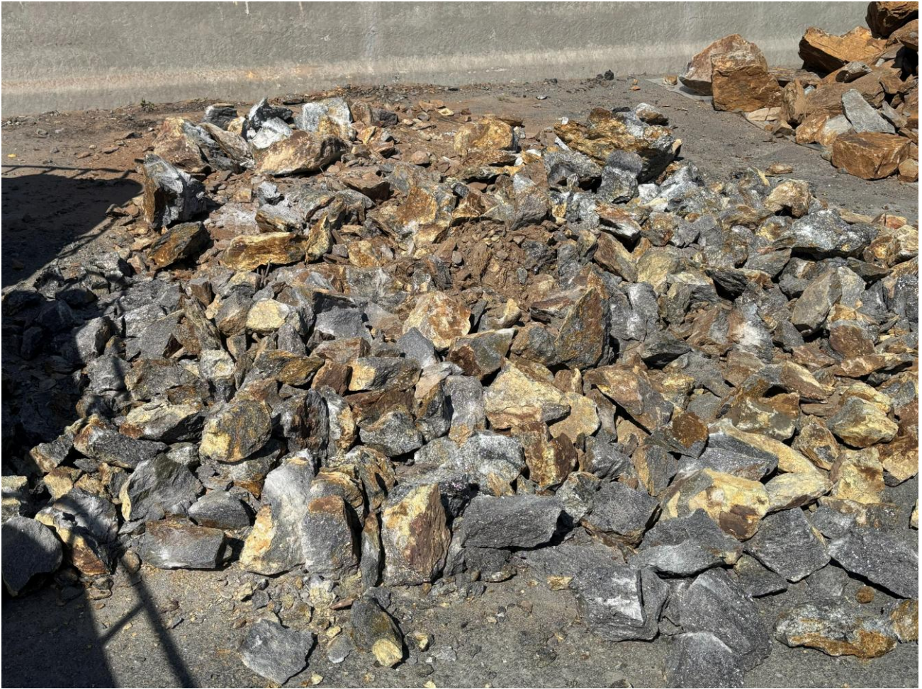
Figur 2. Ferdig knust "mellom-stor" fraksjon klar for å legges i containere.
