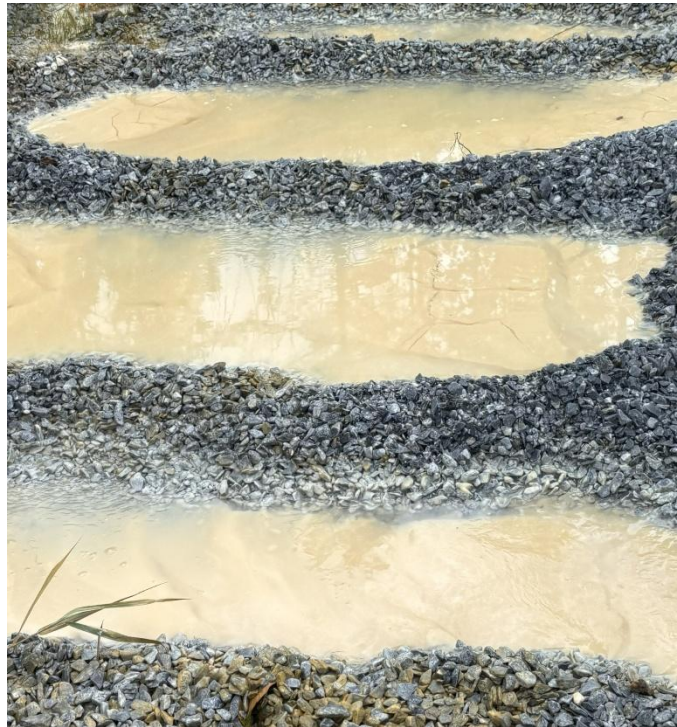
Figur 2. "Fluffy" grå-hvite utfellinging av aluminium. pH i de avbildete bassengene var 6,4.
