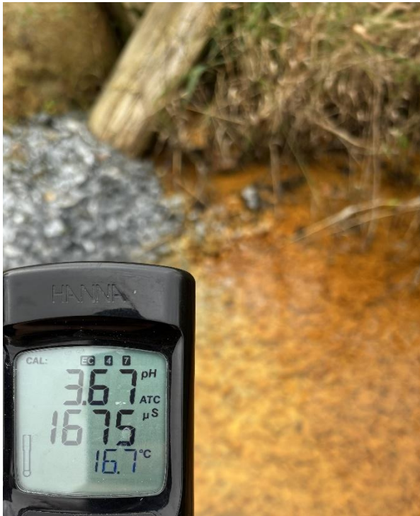
Figur 1. Fra utbyggingsprosjekter i Lillesandsområdet ser man ofte jern-dominerte rustfargede utfellinginger der pH er under 3,8-4 og grå-hvite utfellinginger med aluminiums-forbindelser der pH øker over dette.
