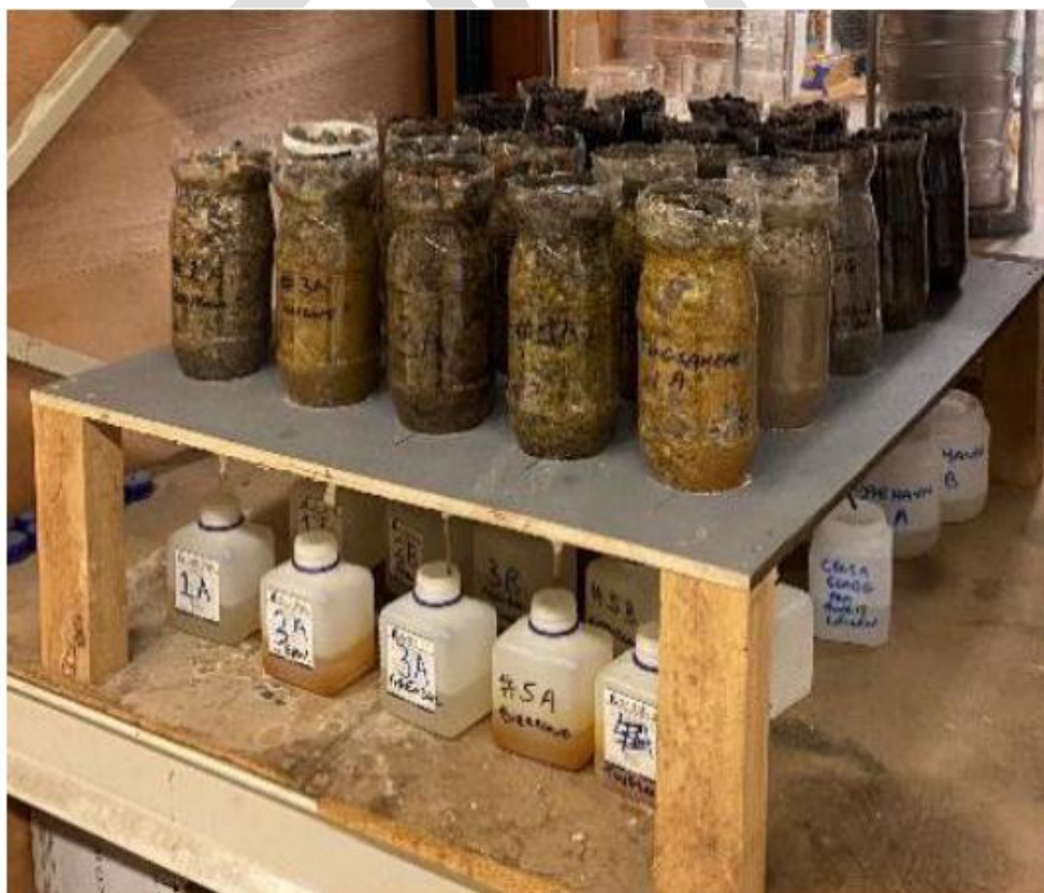
Figur 7. I denne rapporten ble det brukt en svært enkel metode for umettet kolonnetest. Brusflasker med bunnen skåret av, plassert opp-ned i et enkelt stativ. Dette er en metode med svært lave etableringskostnader som krever lite areal og nesten ingen kostnader til drift.
