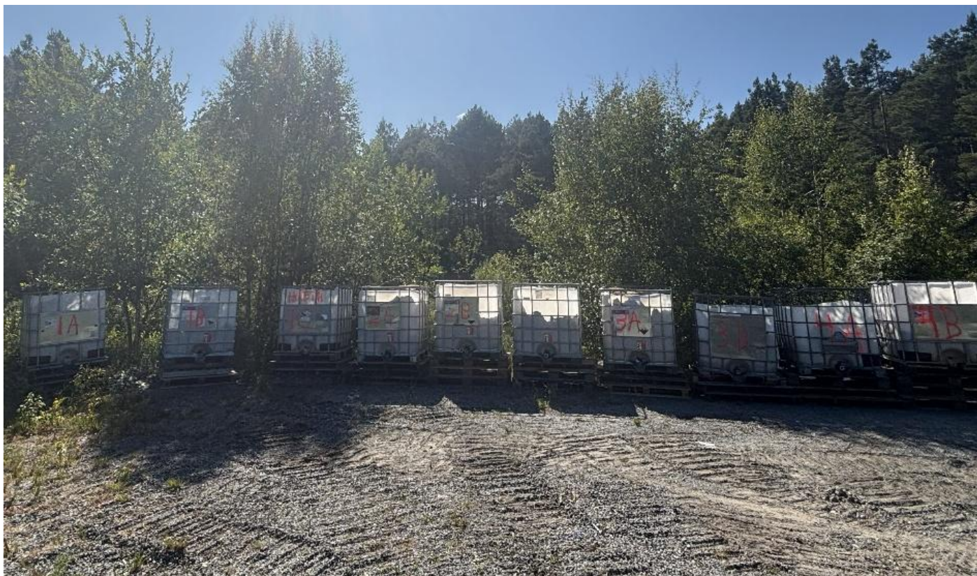
Figur 23. IBC-containerer i felt. Regnvann akkumuleres i containerne over to uker. pH måles og containerne tømmes for vann etter måling.
