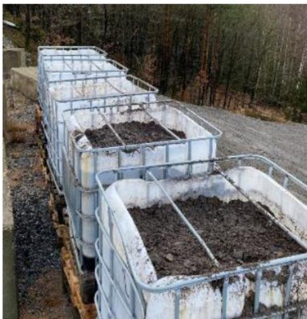
Figur 8. IBC-forsøk der steinmateriale står ute for vær og vind er velegnet til å simulere syredannelse under naturlige forhold. På grunn av store mengder prøvemateriale er metoden også egnet til å redusere usikkerhet knyttet til representative prøver.
