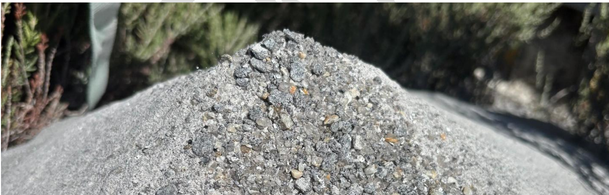
Figur 27. Borestøvsprøver kan være en kilde til ikke-representativt prøvemateriale. Resultater fra analyser av slikt prøvemateriale bør behandles med forsiktighet.
