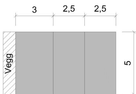
Figur 17: Viser utforming av vinkelrette parkeringsplasser
